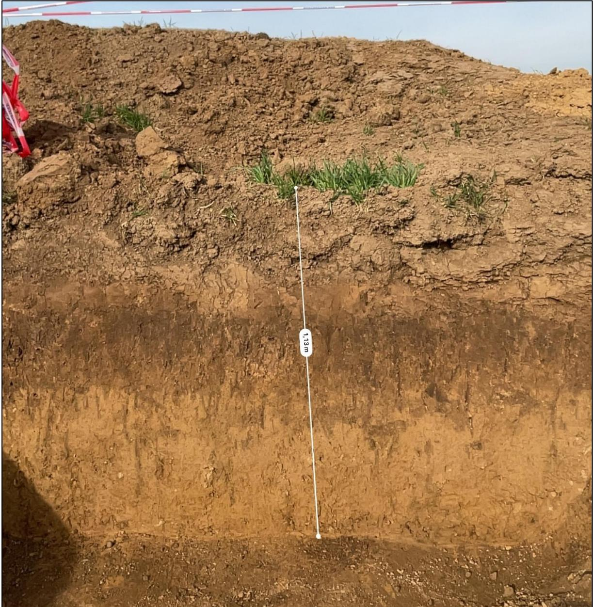
Abbildung 12: Bodenaufschluss im westlichen Plangebiet. Tiefgründige Parabraunerde mit gut erkennbarem Pflughorizont, Al- und Bt-Horizonten, Wurzel- und Regenwurmgingen mit Tontapeten und Lösskindeln (eigene Aufnahme)
